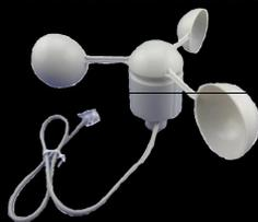
L'anemometro a coppa misura la velocità del vento chiudendo un contatore tramite un magnete che passa attraverso un sensore. L'unità di misura dell'anemometro è km/h.
