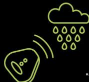
Il sensore non restituisce un valore numerico ma "vero" se sta piovendo e "falso" se non sta piovendo.
